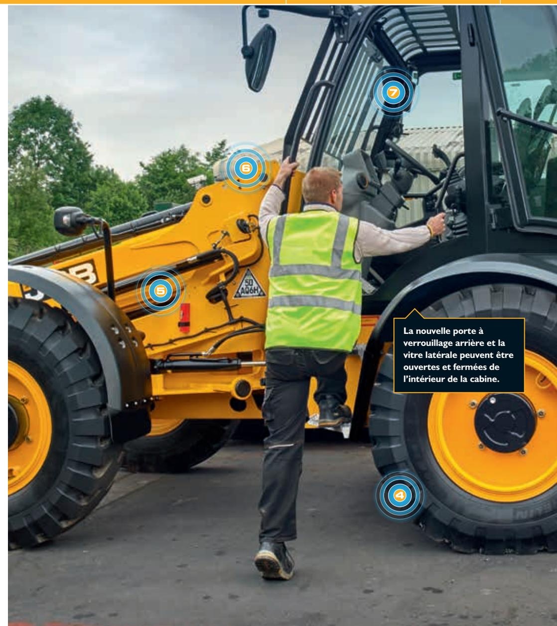
La nouvelle porte à verrouillage arrière et la vitre latérale peuvent être ouvertes et fermées de l'intérieur de la cabine.
