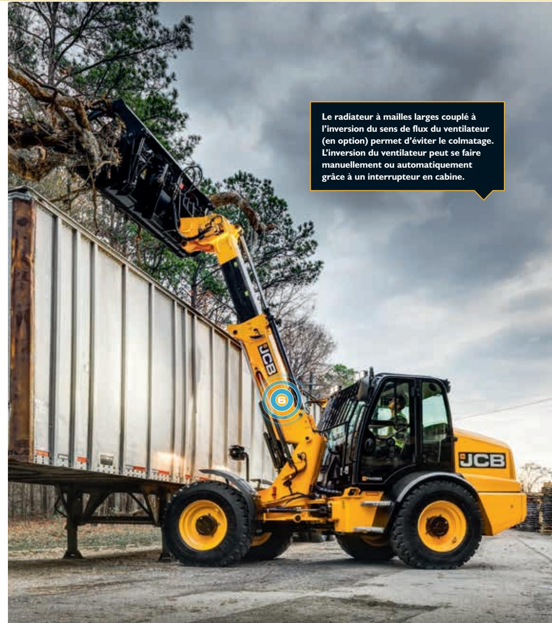
Le radiateur à mailles larges couplé à l'inversion du sens de flux du ventilateur (en option) permet d'éviter le colmatage. L'inversion du ventilateur peut se faire manuellement ou automatiquement grâce à un interrupteur en cabine.
