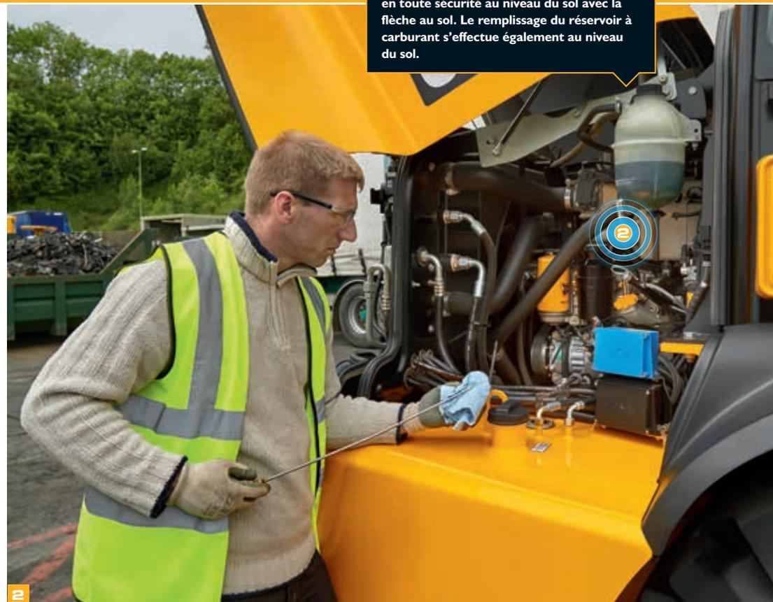
Les contrôles quotidiens peuvent s'effectuer en toute sécurité au niveau du sol avec la flèche au sol. Le remplissage du réservoir à carburant s'effectue également au niveau du sol.
