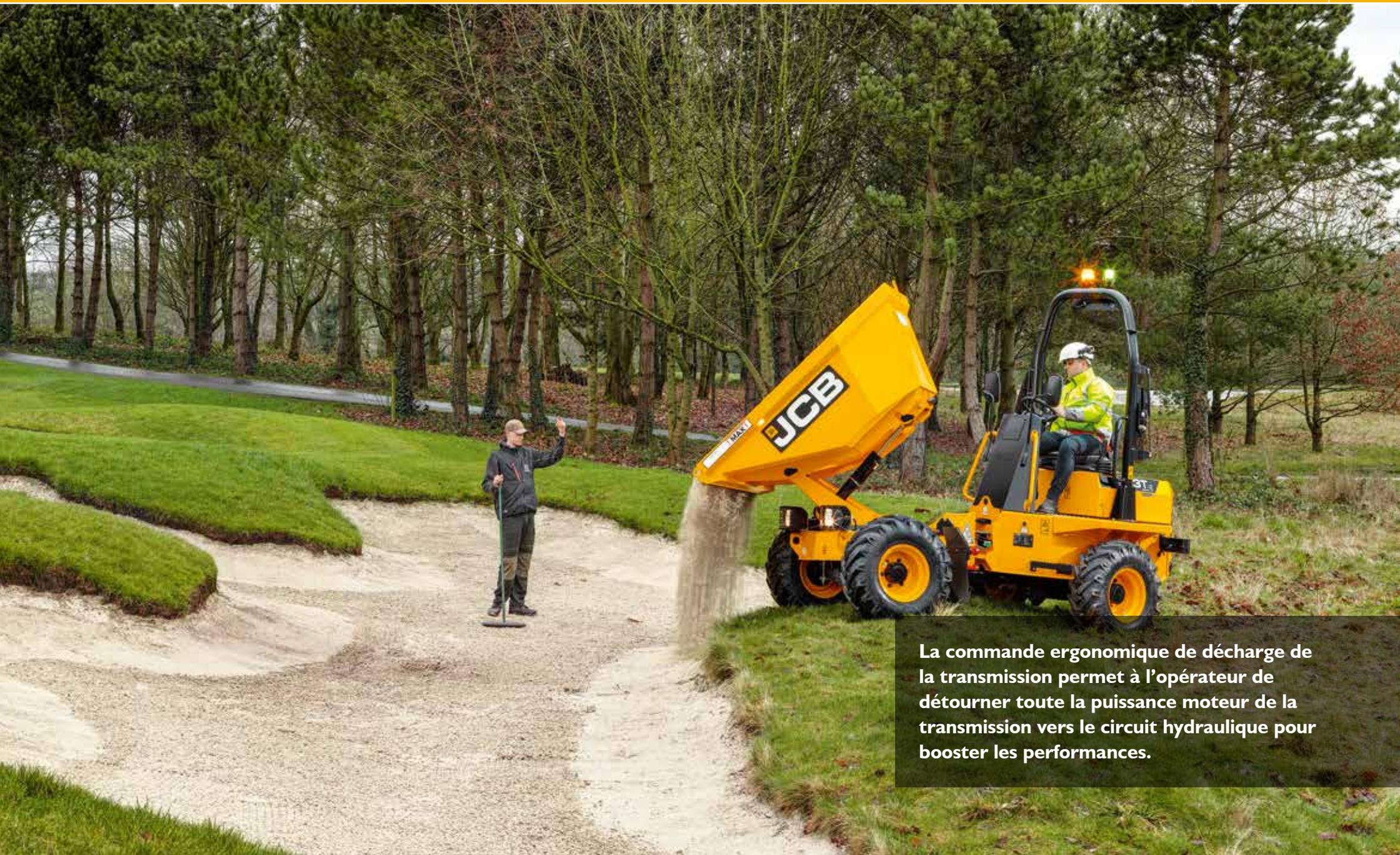
La commande ergonomique de décharge de la transmission permet à l'opérateur de détourner toute la puissance moteur de la transmission vers le circuit hydraulique pour booster les performances.
