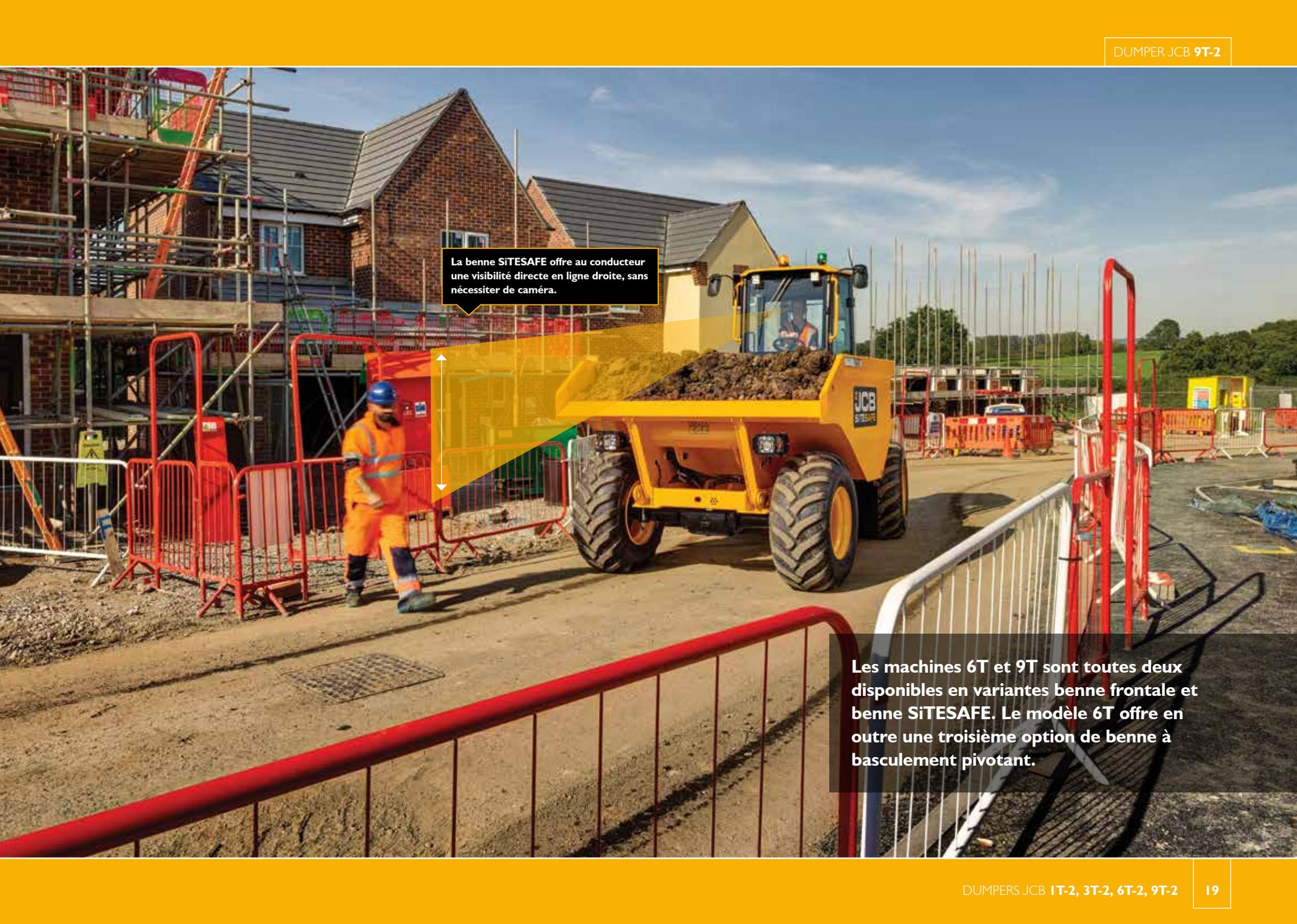
La benne SiTESAFE offre au conducteur une visibilité directe en ligne droite, sans nécessiter de caméra.
