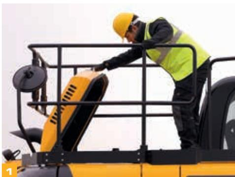
**1** Le capot moteur des pelles JCB JSI 60/180 s'ouvre d'avant en arrière pour offrir un accès facile et sécurisé au moteur.
