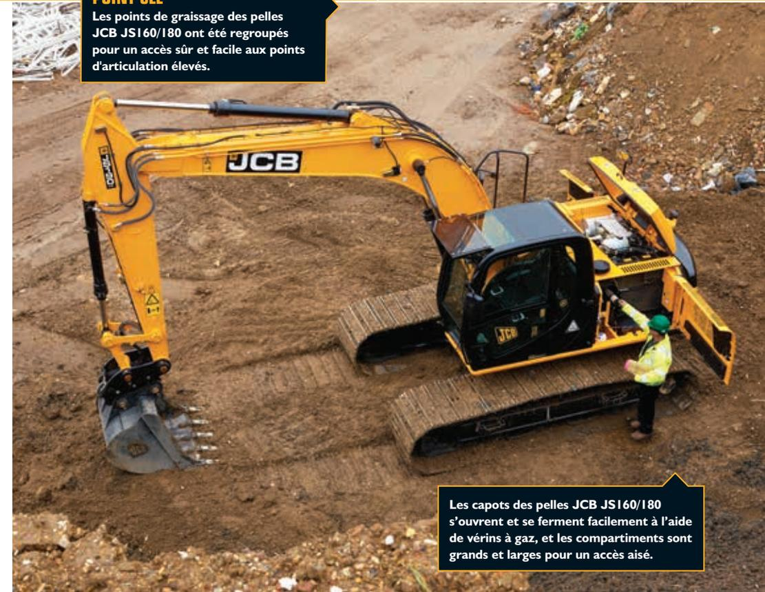
Les capots des pelles JCB JS160/180 s'ouvrent et se ferment facilement à l'aide de vérins à gaz, et les compartiments sont grands et larges pour un accès aisé.
