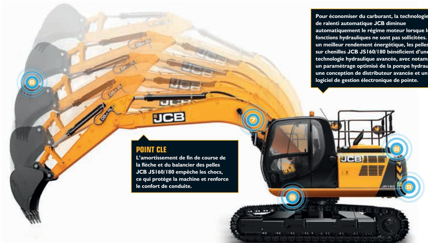
Pour économiser du carburant, la technologie de ralenti automatique JCB diminue automatiquement le régime moteur lorsque les fonctions hydrauliques ne sont pas sollicitées. Pour un meilleur rendement énergétique, les pelles sur chenilles JCB JS160/180 bénéficient d'une technologie hydraulique avancée, avec notamment un paramétrage optimisé de la pompe hydraulique, une conception de distributeur avancée et un logiciel de gestion électronique de pointe.
