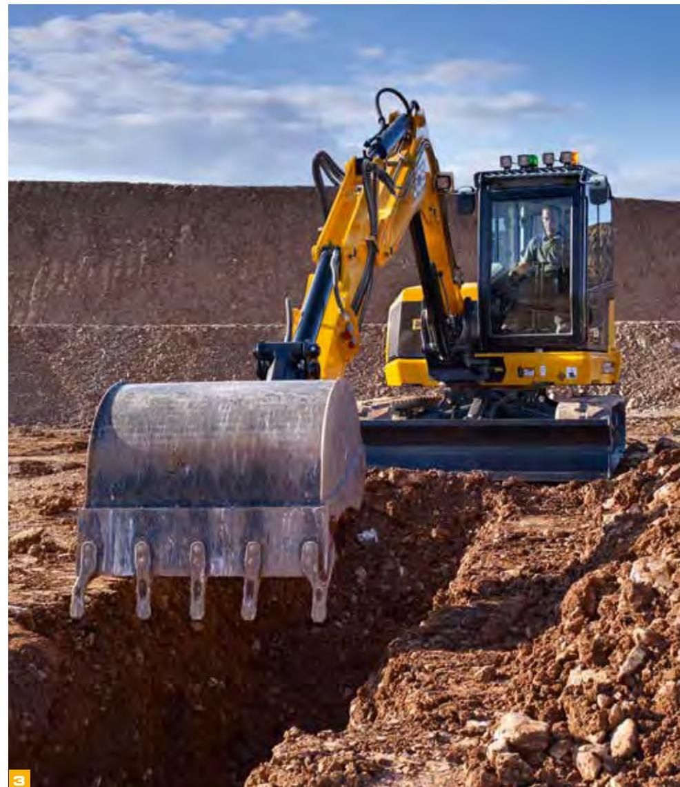
3 La cabine certifiée ROPS et TOPS\* offre une excellente visibilité à l'avant grâce à la répartition 70/30 du pare-brise. Elle offre également une vue dégagée sur la zone de travail avant droite qui simplifie et sécurise les manœuvres et l'excavation de tranchées. Globalement, nous avons amélioré la visibilité verticale de la cabine, rendant le chargement des poids-lourds plus facile et plus sûr.
