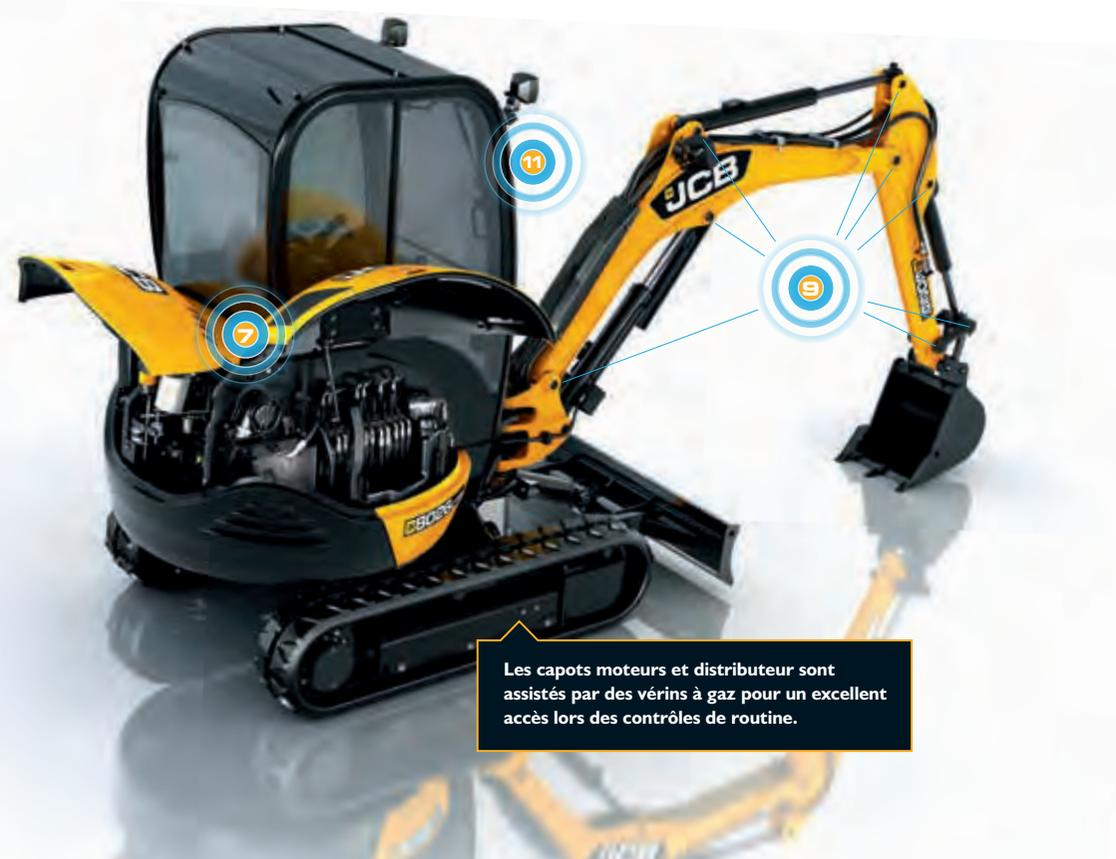
Les capots moteurs et distributeur sont assistés par des vérins à gaz pour un excellent accès lors des contrôles de routine.
