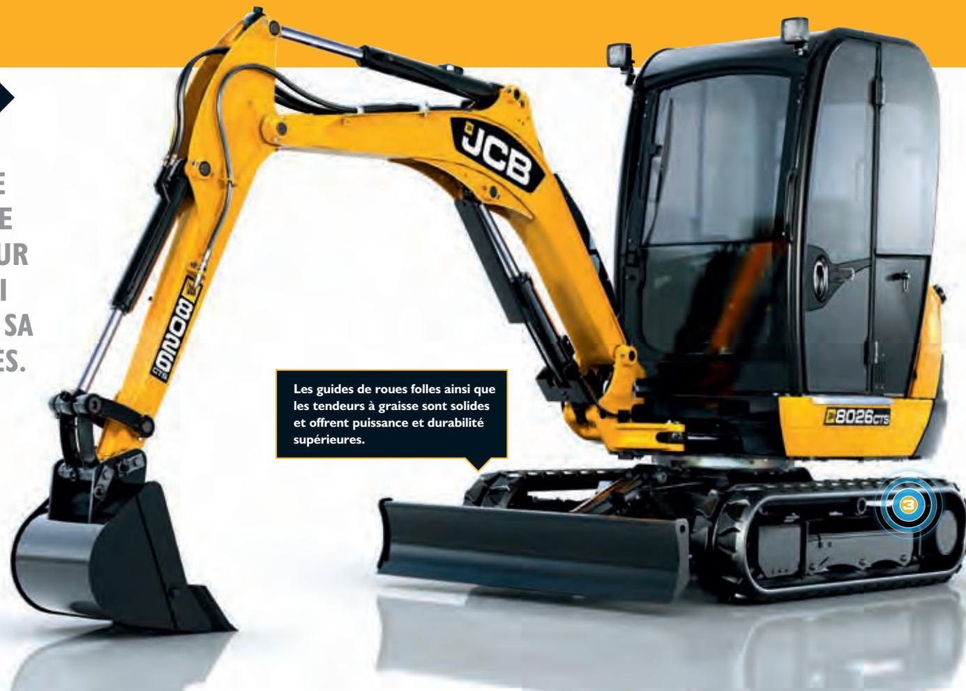
Les guides de roues folles ainsi que les tendeurs à graisse sont solides et offrent puissance et durabilité supérieures.
