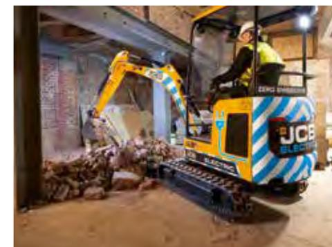
4 Le ralenti automatique simplifie le travail en réduisant le régime au ralenti après une durée déterminée, de façon à optimiser l'utilisation des batteries.
