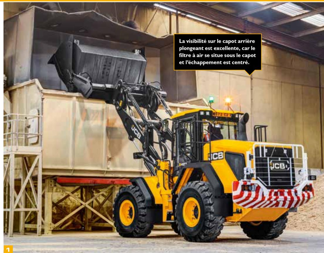
La visibilité sur le capot arrière plongeant est excellente, car le filtre à air se situe sous le capot et l'échappement est centré.
