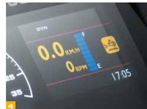
Le moteur est équipé d'un nouvel arrêt automatique qui économise le carburant en coupant le moteur au bout d'un certain temps de fonctionnement au ralenti. Ce délai avant la coupure peut être configuré par l'opérateur depuis le siège de la cabine.
