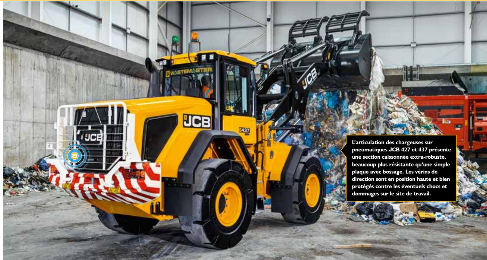
L'articulation des chargeuses sur pneumatiques JCB 427 et 437 présente une section caissonnée extra-robuste, beaucoup plus résistante qu'une simple plaque avec bossage. Les vérins de direction sont en position haute et bien protégés contre les éventuels chocs et dommages sur le site de travail.
