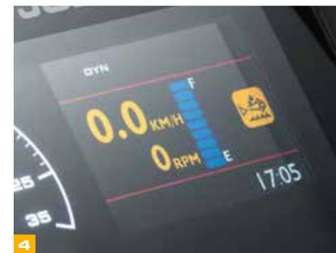
Pour économiser le carburant, la fonction d'arrêt automatique du moteur peut serrer les freins et couper le moteur de la machine en toute sécurité après une durée programmable.
