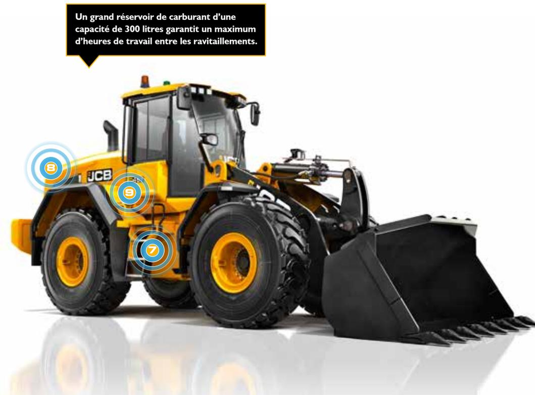
Un grand réservoir de carburant d'une capacité de 300 litres garantit un maximum d'heures de travail entre les ravitaillements.
